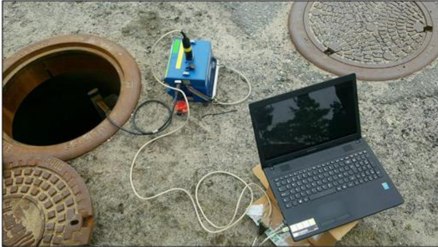
Figur 6. 10: Uthenting av data fra vannmengdemåler (ISCO 2150) i felt
