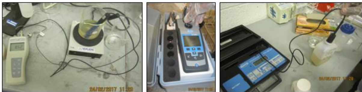
Figur 6. 6: Fra venstre - måling av pH-verdi, turbiditet og ledningsevne
