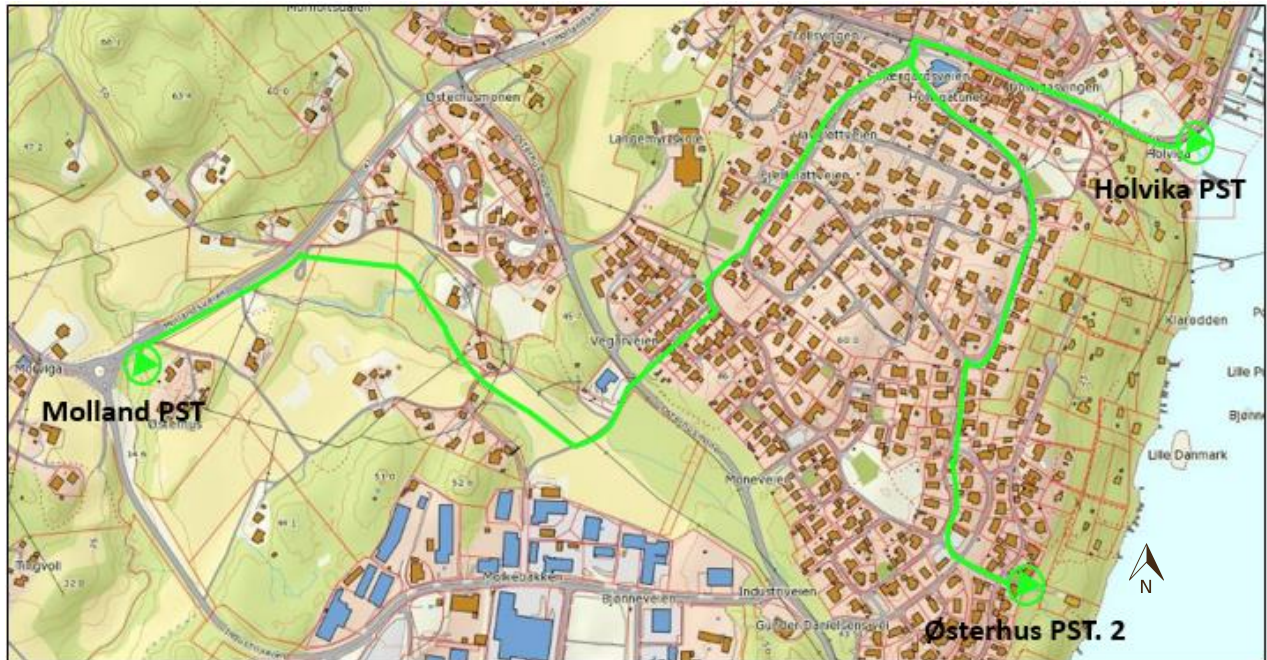
Figur 5. 5: Oversikt over pumpestasjoner som pumper avløpsvann inn til Holvika pumpestasjon
