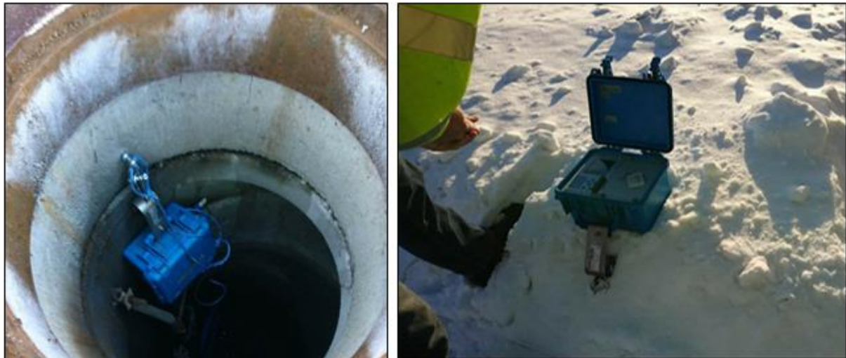
Figur 6. 9: Uthenting av data fra elektronisk vannmengdemåler (Nivus PCM 4) i felt
