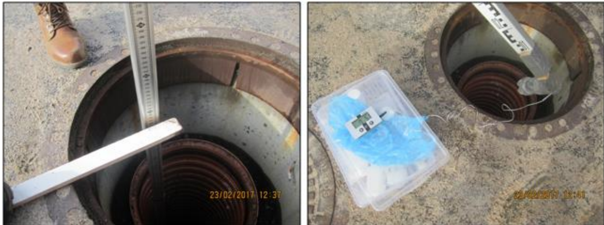
Figur 6. 3: Vannhøyde- og temperaturmåling
